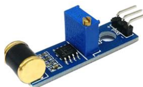
รูปที่ 2 เซนเซอร์วัดการสั่นสะเทือน
