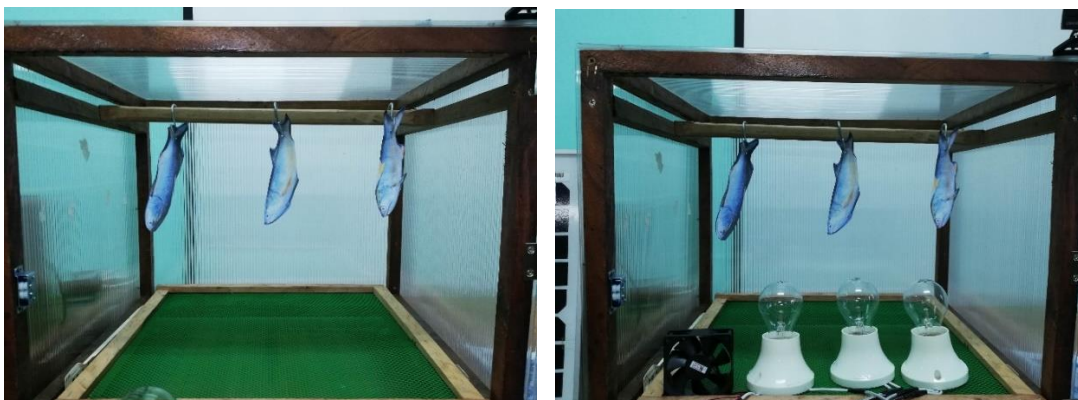
ภาพที่ 3.6 ขึ้นโครงเครื่องอบแห้งพลังงานแสงอาทิตย์
