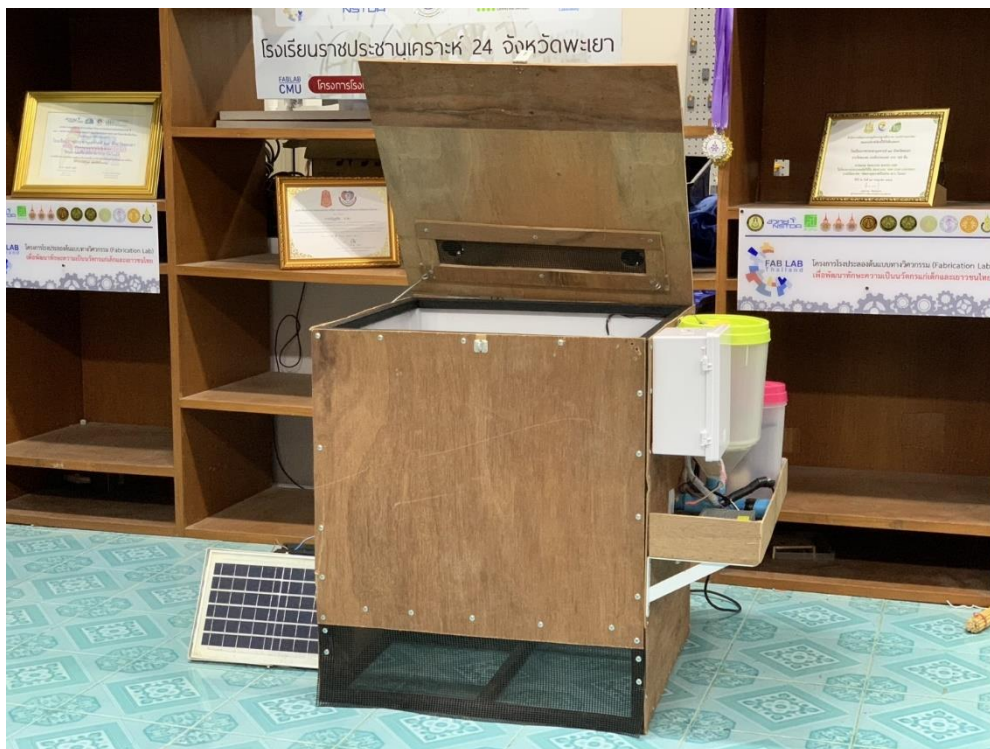
รูปที่ 13 แสดงโครงสร้างจริงของตู้เลี้ยงจิ้งหรีดอัตโนมัติ
