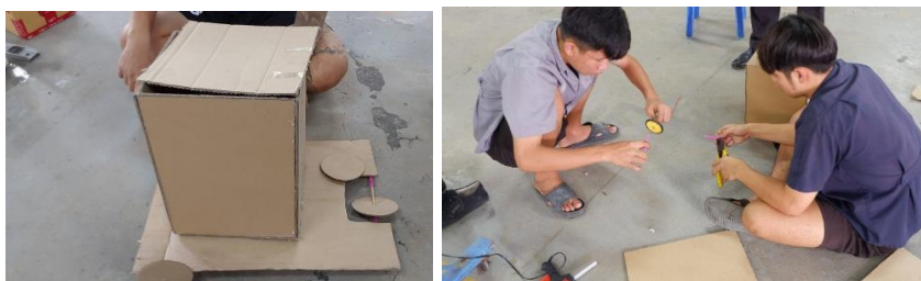
ภาพที่ 3.1 การทำตัวถังรับถังขยะ การสร้างต้นแบบจากกระดาษลูกฟูก และการประกอบมอเตอร์เกียร์
