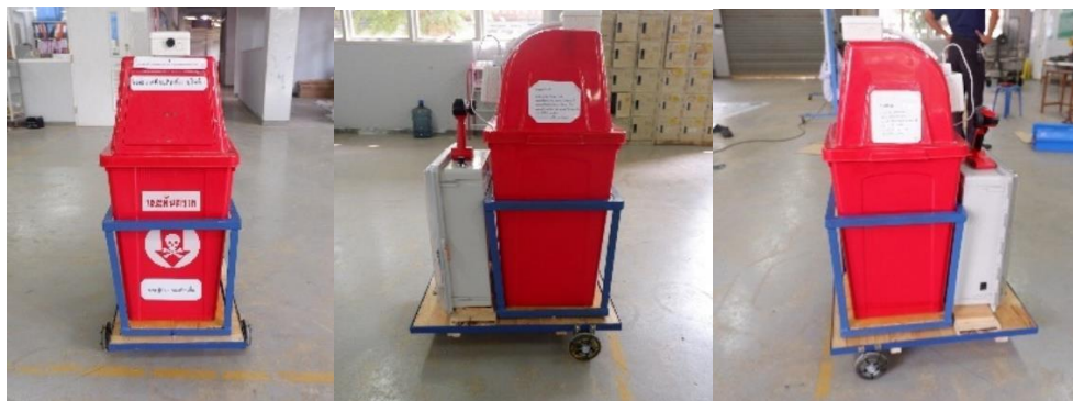
ภาพที่ 3.7 ถังขยะอัจฉริยะขับเคลื่อนด้วยพลังงานไฟฟ้า
