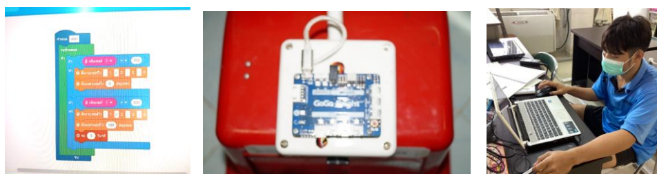
ภาพที่ 3.3 การติดตั้งระบบควบคุมด้วยสวิตช์ ลงโค้ดเชื่อมต่อบอร์ด Go Go Bright
