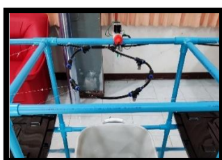
การต่อระบบท่อน้ำ และรดน้ำอัตโนมัติ
