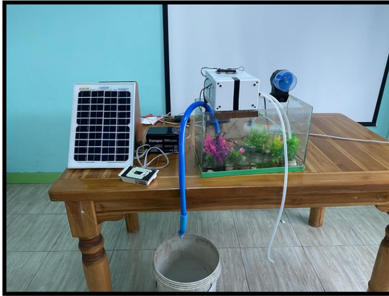
ภาพที่ 3.2.25 นำเครื่องบำบัดน้ำเสียจากพลังงานแสงอาทิตย์ไปทดสอบในน้ำเสียของตู้ปลา
