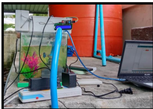
ภาพที่ 3.2.24 ติดตั้งระบบเข้ากับโครงสร้างของเครื่องบำบัดน้ำเสียจากพลังงานแสงอาทิตย์พร้อมทดสอบระบบ
