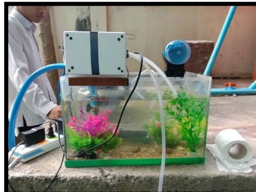
ภาพที่ 3.2.24 ติดตั้งระบบเข้ากับโครงสร้างของเครื่องบำบัดน้ำเสียจากพลังงานแสงอาทิตย์พร้อมทดสอบระบบ
