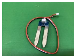
แผงวงจรตรวจจับสภาพดิน
