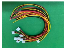
สายไฟจัมเปอร์
