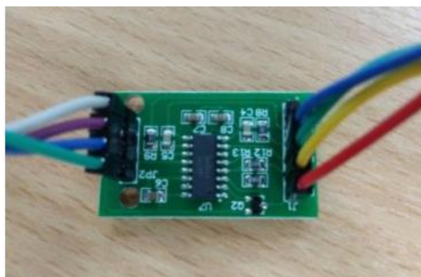
รูปภาพ แสดง โมดูล HX711 ซึ่งเป็นโมดูลขยายสัญญาณจาก Load cell
