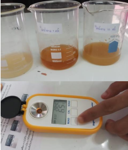
1. หาปริมาณแอลกอฮอล์ โดยใช้เครื่องวัดปริมาณแอลกอฮอล์แบบพกพา
