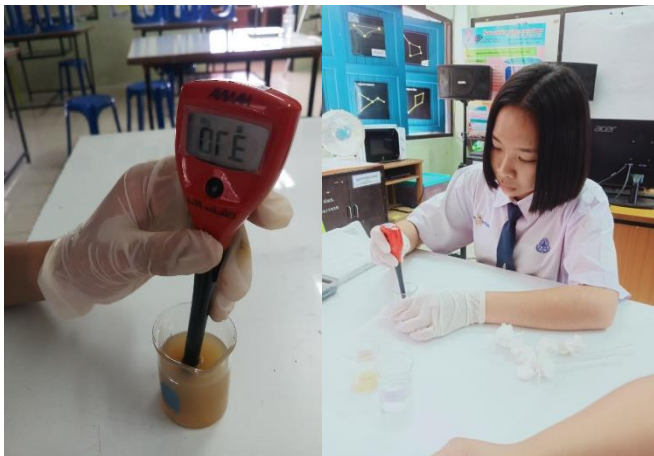
4. วัดค่าความเป็นกรด-ด่าง (pH) โดยใช้เครื่องวัดค่าความเป็นกรด-ด่าง (pH meter)
