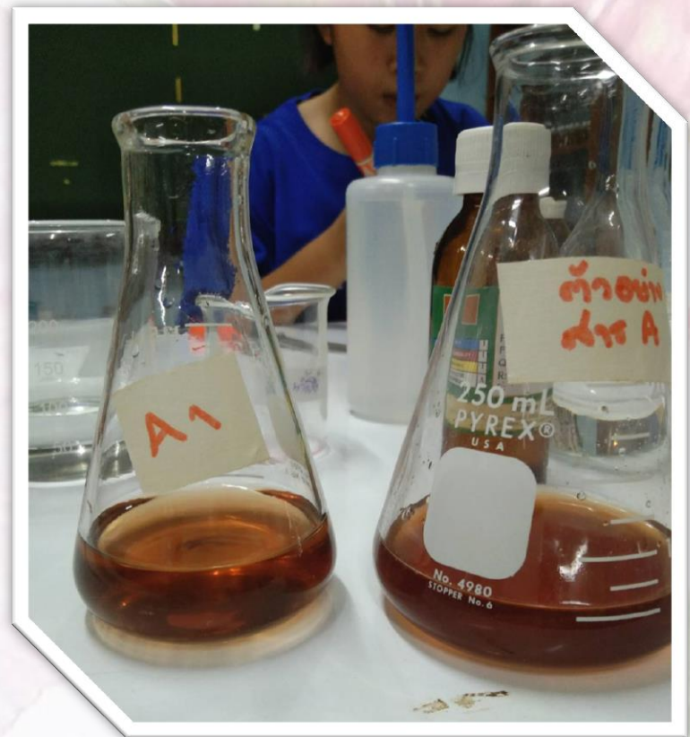
ตัวอย่างน้ำหมักจากกระเจี๊ยบแดงสายพันธุ์ชูดานที่ผ่านกระบวนการไทเทรตเพื่อหากรดอะซิติก
