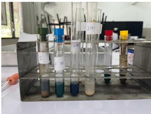
รูปที่ 6 การตรวจวัดค่า KPN และ PH ในดินแปลงที่ 2
