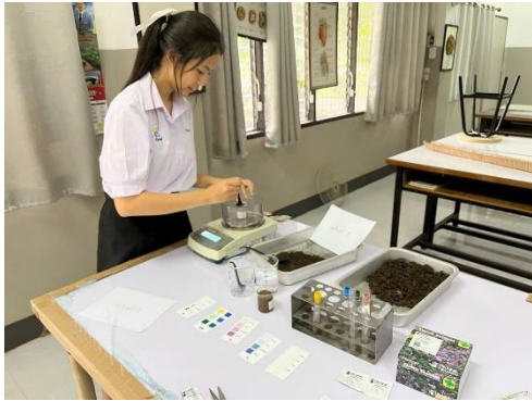
รูปที่ 4 การตรวจวัดค่า KPN และ PH ในดิน
