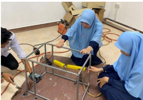
ภาพที่ 3.5 เชื่อมเหล็กเพื่อทำโครงสร้าง
