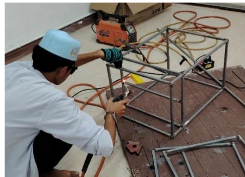
ภาพที่ 3.5 เชื่อมเหล็กเพื่อทำโครงสร้าง
