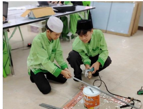
ภาพที่ 3.4 วัดความยาวของเหล็กและตัดเหล็กให้พอดี ขนาด 40*35*60 ตามโครงสร้างที่ตั้งไว้
