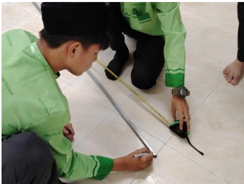
ภาพที่ 3.4 วัดความยาวของเหล็กและตัดเหล็กให้พอดี ขนาด 40*35*60 ตามโครงสร้างที่ตั้งไว้
