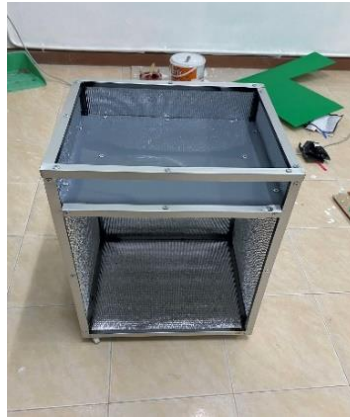
ภาพที่ 3.7 ดำเนินการประกอบโครงสร้างตู้เพาะเลี้ยงเห็ดโคนอัตโนมัติ
